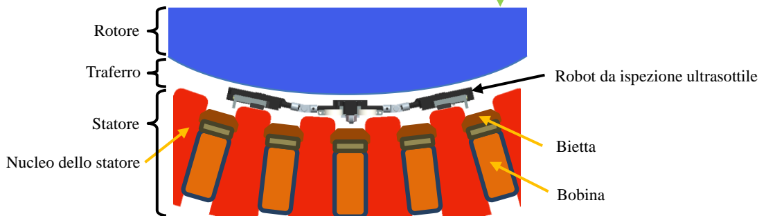
Vista in primo piano del generatore
