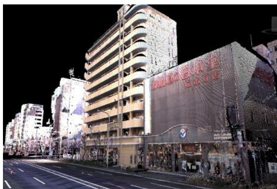
Esempio 4: Misurazione dettagliata dell'aspetto degli edifici con scanner laser a lungo raggio o ad alta densità
