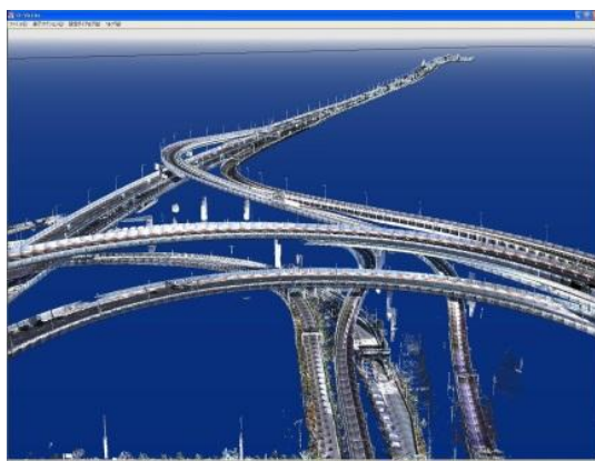
Esempio 2: Misurazione 3D degli svincoli con scanner laser standard e sovrapposizione sulle immagini della telecamera a colori
