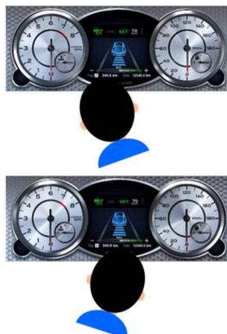
Lucentezza e sfumatura cambiano in tempo reale, in base all'angolo di visualizzazione
