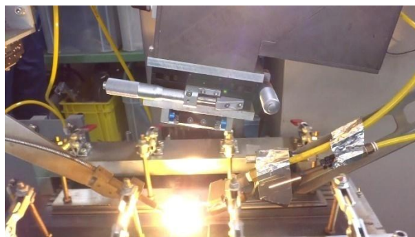
Fig. 1. Confronto visivo degli schizzi di metallo fuso durante la saldatura con laser in fibra
