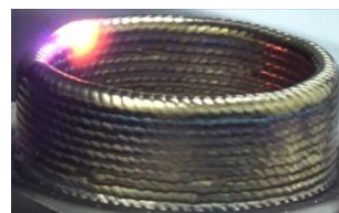
Dot Forming (accumulo di calore minimo)
