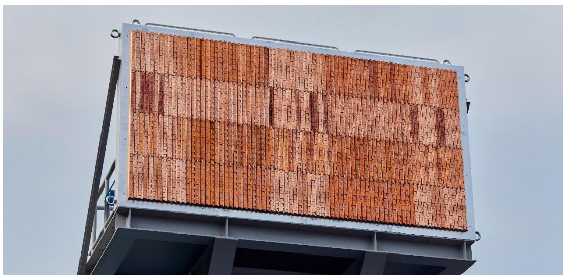
Prototipo di antenna ad array a guida d'onda fessurata, realizzata in resina stampata a iniezione
