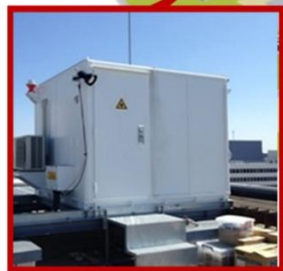
Terminal Doppler Lidar Per rilevare il wind shear in assenza di precipitazioni
