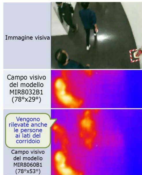
Immagini visive e termiche dal lato della stanza (persone che camminano nel corridoio)
