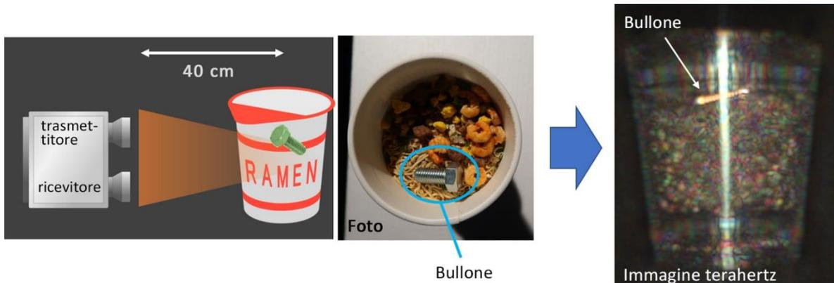
Risultati del test di ispezione non distruttiva (rilevamento del bullone metallico all'interno della confezione di noodle)
