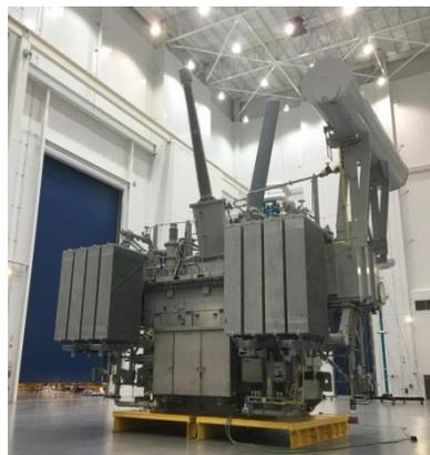
Trasformatore da 765 kV a elevata capacità
