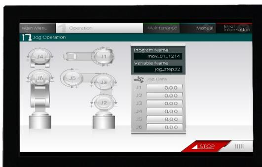
Modulo TFT-LCD a colori con pannello touchscreen capacitivo proiettato
