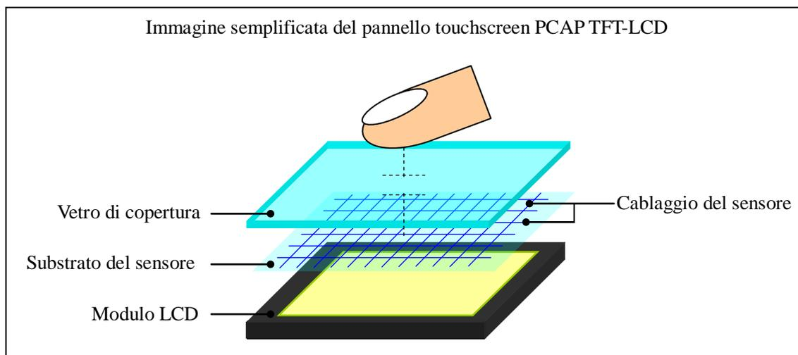
**Linea di moduli TFT-LCD a colori con pannelli touchscreen capacitivi** (nuovi moduli in grassetto)
