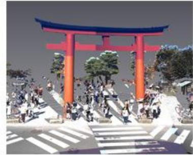
Nuvole di punti 3D create dai dati ottenuti tramite MMS
