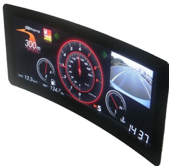
Modulo TFT-LCD curvo a colori dotato della tecnologia sviluppata di recente (raggio di curvatura di 800 mm)
