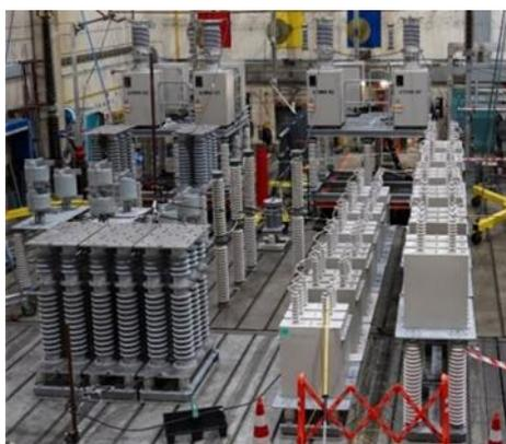
Il prototipo di interruttore di circuito meccanico in corrente continua da 160 kV utilizzato per i test
