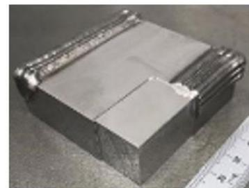
Esempio di saldatura a riporto, adatta per interventi di riparazione
